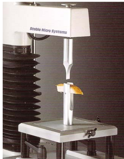
Figura 2. Texturómetro preparado para evaluar la textura de un alimento mediante un instrumento que imita los dientes incisivos
